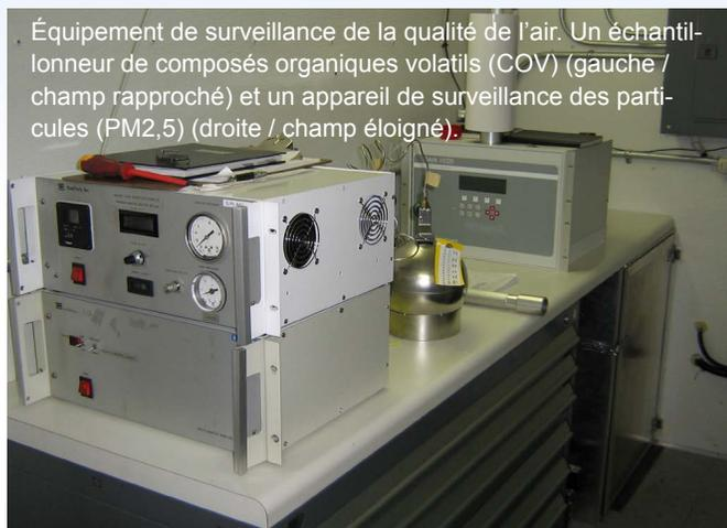
Équipement de surveillance de la qualité de l'air. Un échantillonneur de composés organiques volatils (COV) (gauche / champ rapproché) et un appareil de surveillance des particules (PM2,5) (droite / champ éloigné).
